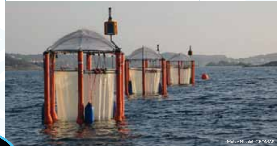
Die Mesokosmen sind schwimmende Experimentieranlagen im Meer. Mit ihnen untersuchen Forscher und Forscherinnen unter anderem, wie das marine Ökosystem auf die Ozeanversauerung reagiert.
