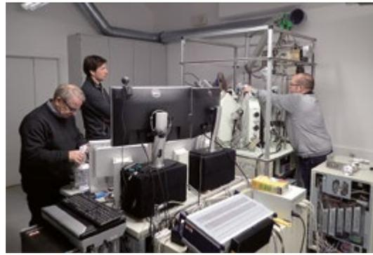
Den Servicetechnikern der Firma Jeol J. Börder (li), J. Lachner (mi) und T. Königs (re) gelang es, die komplett zerlegte Elektronenstrahlmikrosonde wieder in Funktionsbereitschaft zu bringen.
