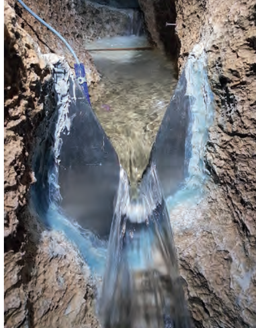
Hydrologische Messstelle im Furtowischacht (Hochschwab, Steiermark).
